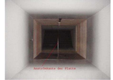
Abb. 2: Experimentierstrecke des Windkanals mit ebener Platte zur Untersuchung des Transitionsprozesses in der anfangs laminaren Grenzschicht der Platte.
